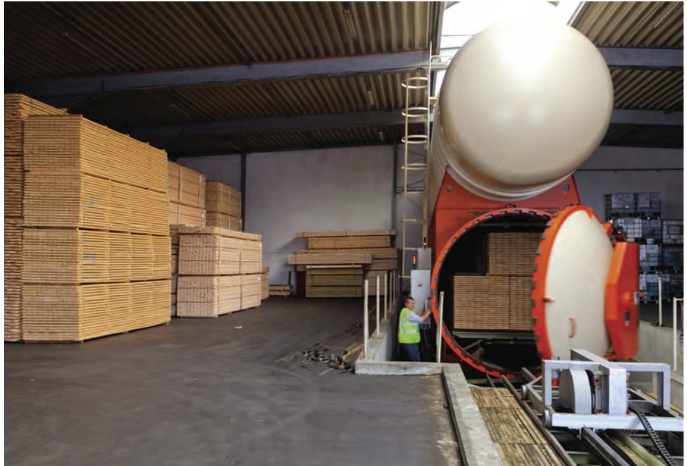
Verduurzaming onder druk met behulp van de impregneerketel
